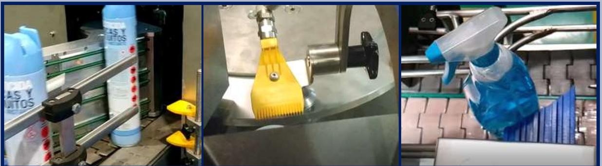
Sistemas de expulsor neumático - De bandas - Progresivos - Soplado
